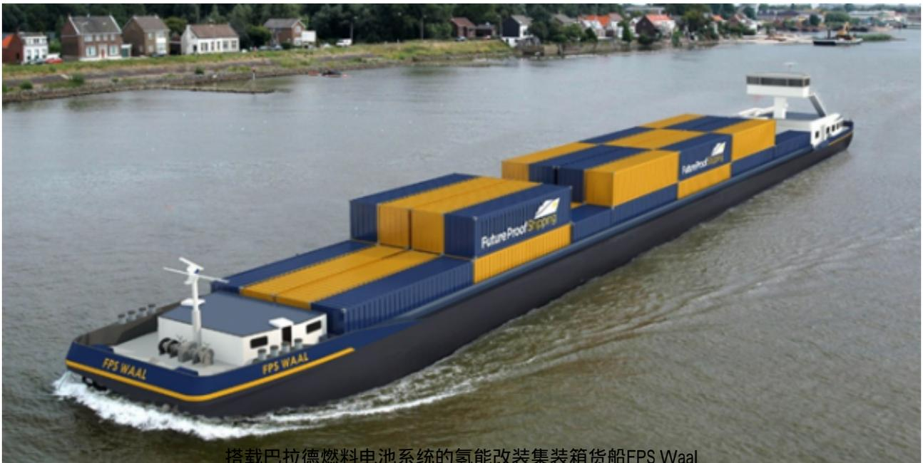
搭载巴拉德燃料电池系统的氢能改装集装箱货船FPS Waal
