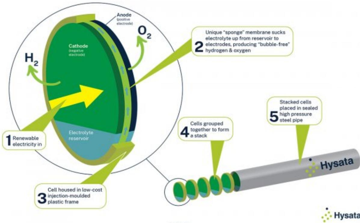
该技术有可能通过减少电力投入来降低可再生氢生产的成本。该技术还降低了设备成本，降低了电阻，从而降低了冷却要求。
