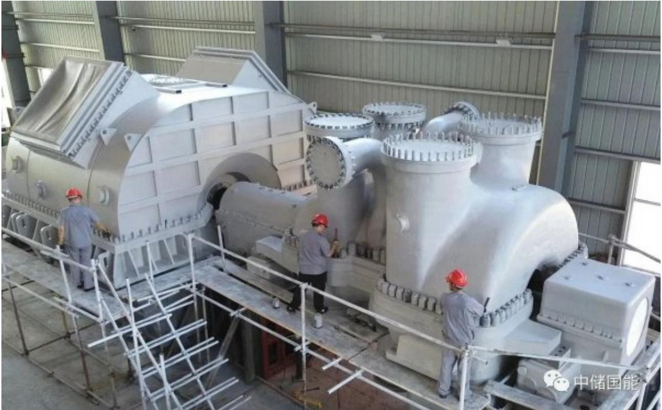
2023年8月1日，中国科学院工程热物理研究所和中储国能公司完成了300MW压缩空气膨胀机的集成测试，各项测试结果均达到或超过设计指标，具有集成度高、效率高、启停快、寿命长、易维护等优点。该300MW压缩空气膨胀机的成功研制，是我国压缩空气储能领域的重要里程碑，推动了我国先进压缩空气储能技术迈向新的台阶。
