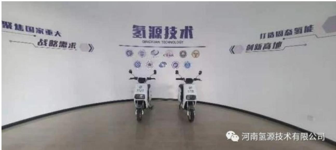
在交通领域，河南氢源打造的固态氢能两轮车是在普通两轮电动车的基础上，增加氢燃料电池、储氢容器等模块。
