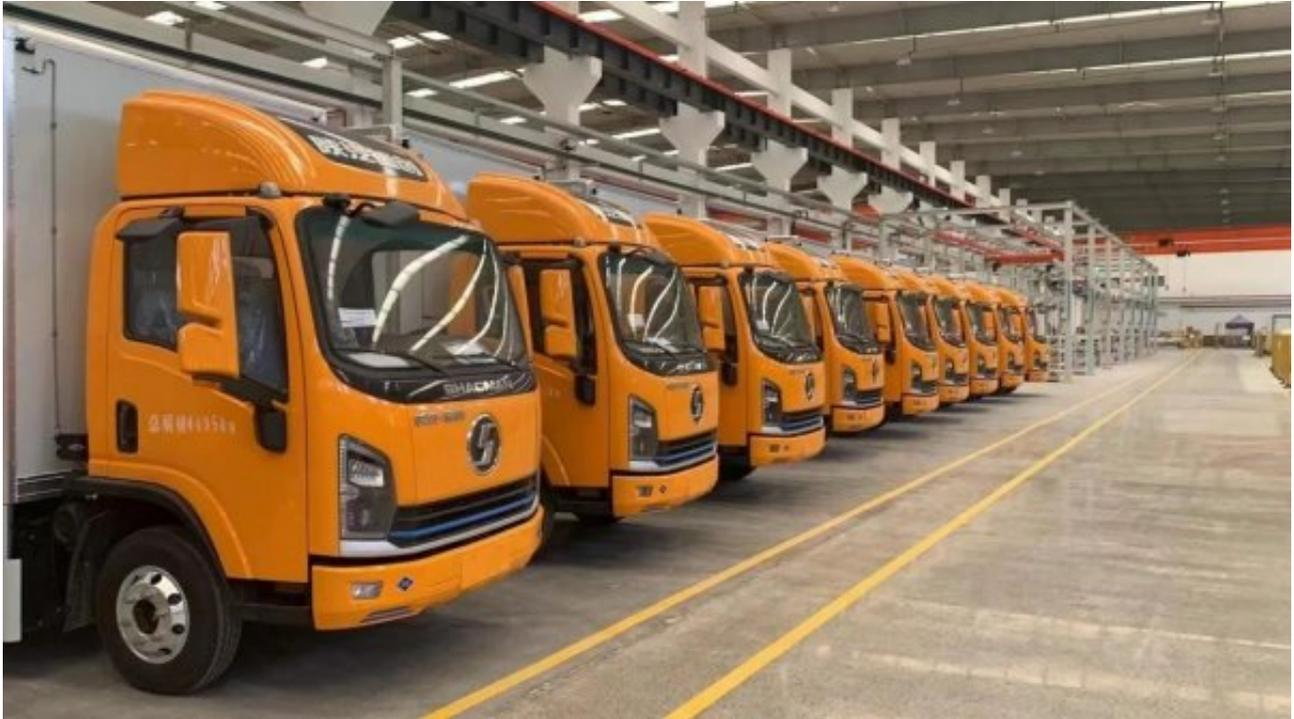
此批上线的车辆为4.5吨氢燃料物流车车型，将主要服务于包括上海地区区域内快递、物流和工业运输等领域，助力加快推进运输领域绿色低碳转型。该批氢燃料物流车，配套搭载微宏动力多元复合锂电池，可实现3C充电倍率以及4C放电倍率，能满足氢燃料车型启动时需要大电流供电以及边跑边充等特性。值得一提的是，微宏动力电池除了在运行中由电池提供车辆启动、加速、减速等非稳态下所需的大功率外，还可以在车辆制动时起到能量回收储存等协助作用，最大限度保障了能量的充分有效利用。
