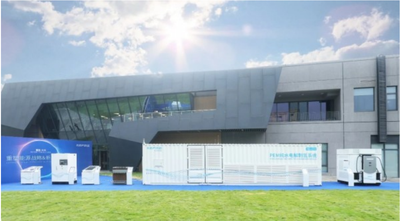
100Nm 3 /h的PEM纯水电解制氢系统基于重塑能源成熟的系统设计能力和控制技术开发，产氢效率为80%，具备5%-150%宽负荷调节范围，对可再生能源发电波动的适应性强；同时通过优化冷却系统降低了约10%的综合能耗。
