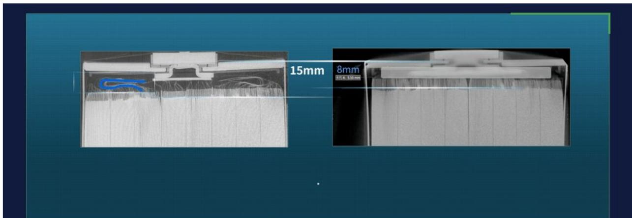
瑞浦兰钧的电芯结构技术具有三大优点：一是去掉了极耳的U型弯折，让电芯结构变得更稳定，提升安全性；二是极耳更短且与盖板实现了一体化连接，一定程度上减小了内阻，令过流能力得到增强；三是电池空间利用率提升，体积能量密度更大，达到了450Wh/L。
