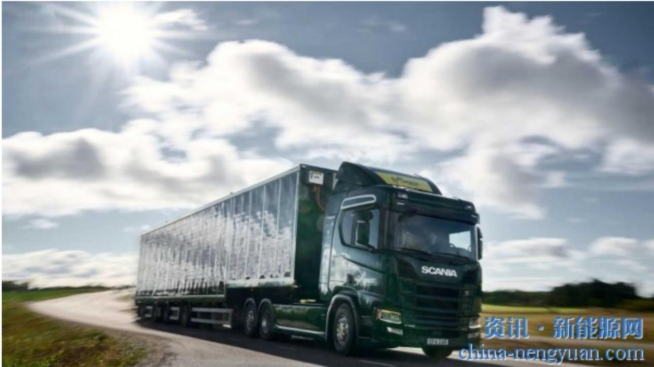
斯堪尼亚（SCANIA）最近开始测试一辆太阳能卡车，这是一辆560马力的插电式混合动力卡车，拖车上包裹着薄膜太阳能电池板。这一独特的装置目前正在瑞典的公共道路上进行测试，是斯堪尼亚与工业界和学术界合作伙伴为期两年的研究合作的结果。
