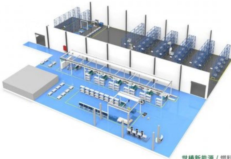
世椿新能源 / 燃料电池系统装配线
