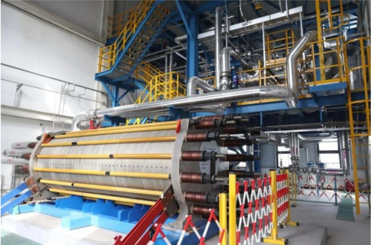
该测试平台设计测试能力500-1500标方，测试对象覆盖目前主流的碱性电解水制氢电解槽和整流器。平台基于化工安全理念构建了多级安全防护系统，采用了创新的工艺流程和全方位的检测监控系统，能评价不同电解水制氢系统的稳态特性，并在线获取整流器、电解槽、气液分离等核心部件的技术指标，为大型并网或离网制氢示范工程提供设备选型、型式试验及运行验证工作；为电解水制氢系统的质量评价和标准制修订工作提供实际数据支撑。
