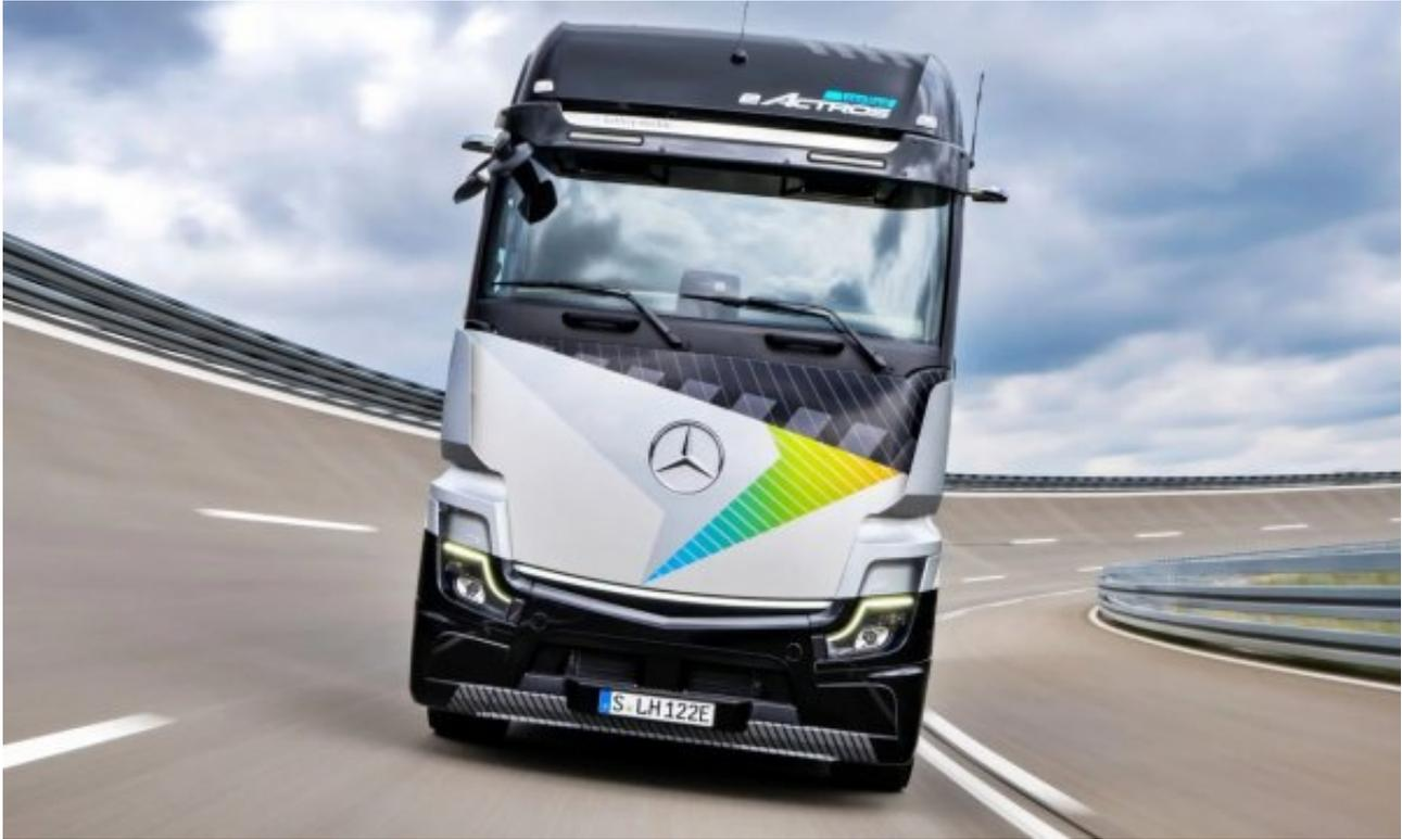
有趣的是，制造商声称，即使没有稍后在卡车系列中启用的兆瓦级充电(MCS)，eActros 600也可以通过中间充电每天行驶1000公里以上。使用MCS，卡车可以在大约30分钟内完成20%到80%的充电，充电站的输出大约为1MW。
