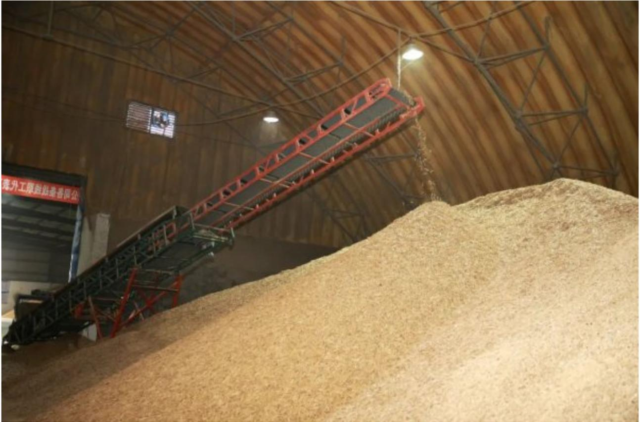
走进农场大川新能源生物质颗粒燃料加工厂，机器轰鸣声不绝于耳，一座座堆积如山的稻壳原料正等待进入生产加工车间。随着工人将稻壳铲置在造粒机输送带上，经粉碎机、烘干机、造粒机的挤压制粒，废弃稻壳被加工为一截截寸把长、如粉笔粗的光滑圆柱状生物质颗粒燃料，摇身一变成为炙手可热的清洁能源。
