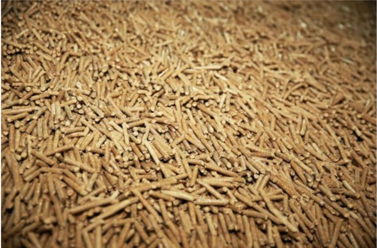
“这就是生物质燃料颗粒成品，作为一种可直接燃烧的新型清洁燃料，可代替煤炭在锅炉中直接燃烧进行发电或供热，燃尽的灰分还能作为有机肥用于农业生产。”农场副总经理唐亮手捧一把颗粒成品说，近年来，农场立足水稻生产专业场和工业园区40万吨产能的优势，与哈尔滨鑫华科技有限责任公司合作打造生物质供热联产项目，将供热燃料由原煤更换为生物质颗粒，取得了可观的效益。
