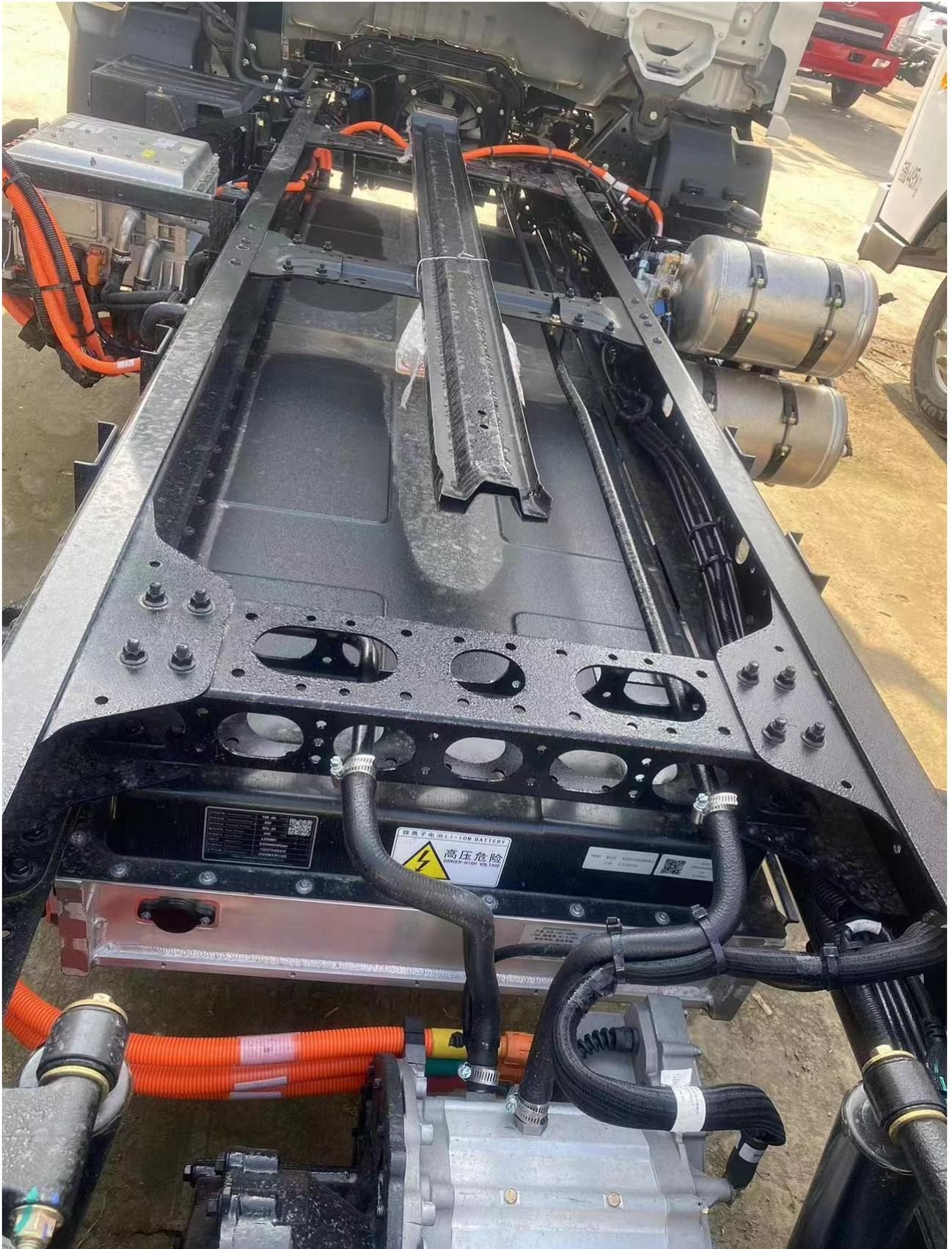
蓝擎·悦EH搭载宁德时代全新一代磷酸铁锂电池组，容量为100.46kWh，最大可支持车辆续航320km。电池采用单包中置的布局方式，有益降低车辆重心，电池托架采用超高强钢材质，在保证安全的前提下降低车辆自重。
