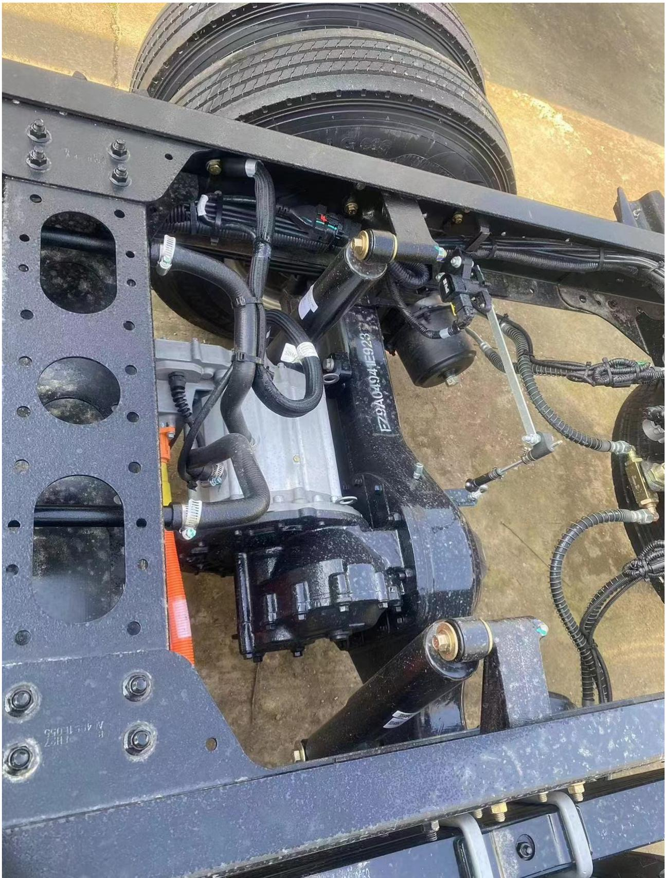
因为是中置电池的缘故，所以蓝擎·悦EH采用的是结构简便，传动效率更高的双档电驱桥系统。该电驱桥峰值功率120kw，峰值扭矩高达360N.m，可实现快慢两档调速，具备动能回收功能，全工况下减少电量损耗。并且其驱动电
