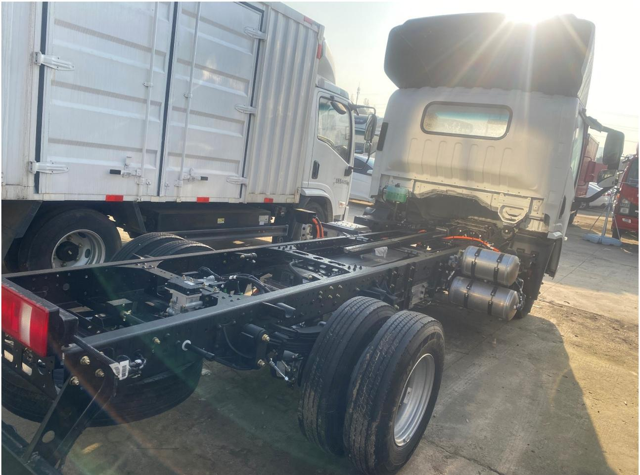
轻卡的承载能力同样是关键，蓝擎·悦EH的大梁采用800x180（mm）的规格，可承载5吨重量，基本涵盖所有城配的运载工况。且大梁采用燕尾梁设计，在保证承载能力的同时还可以降低车辆自重，实现轻量化和多拉快跑。
