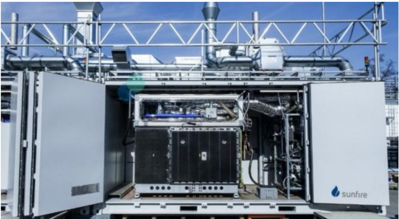
世界上最大的固体氧化物氢电解槽(SOEC)安装在美国宇航局(NASA)位于加利福尼亚的设施中。
