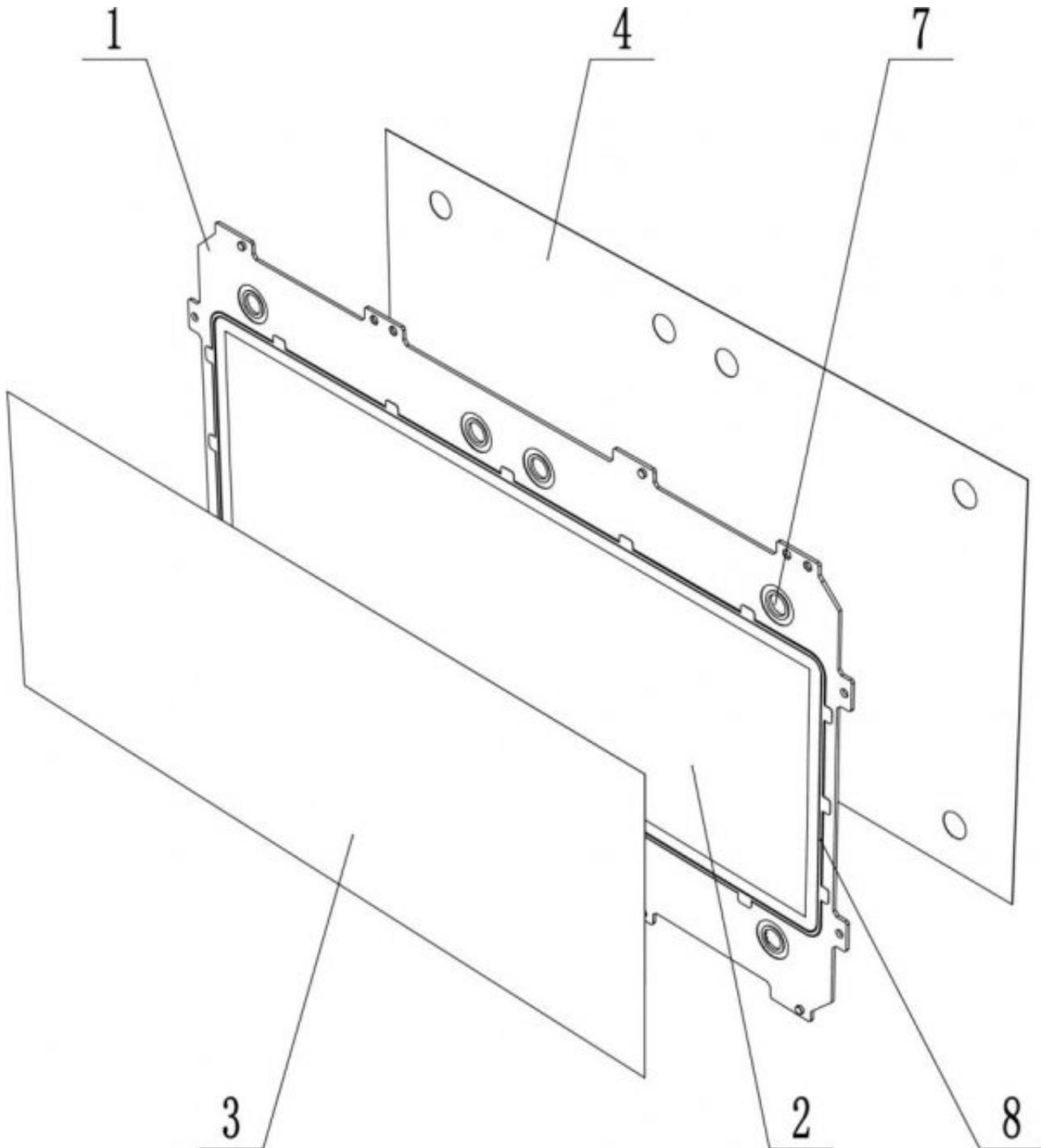
摘要: 本实用新型提供了一种隔膜免打孔全钒液流电池结构, 包括液流框、碳毡、隔膜和两个端板, 所述碳毡安装在所述液流框中部, 所述液流框的上沿和下沿分别开设有一排进出液口, 所述隔膜的上、下边缘完全落在两排所述进出液口之间, 所述液流框围绕所述碳毡开设有一圈密封槽, 所述密封槽的上、下边缘也完全落在两排所述进出液口之间, 所述密封槽内安装有密封胶条, 所述隔膜的边缘贴装在所述密封胶条上。该隔膜免打孔全钒液流电池结构具有设计科学、无需在隔膜上打孔、安装方便、实用性强的优点。
