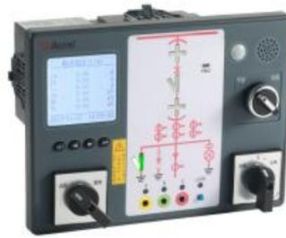
一次回路模拟图及开关状态
