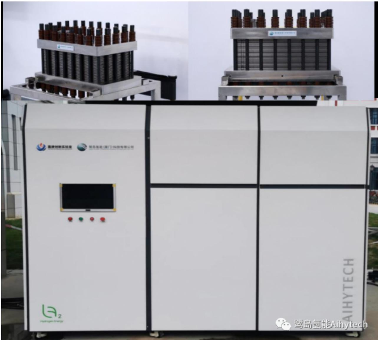
SIL认证基于IEC61508, IEC61511等标准对安全设备的安全完整性等级（SIL）或者性能等级（PL）进行评估和确认的一种第三方评估、验证和认证。本次SIL3证书的取得，充分证明了鹭岛氢能团队在电解水制氢设备的研发设计、制造和运行过程中都满足了严格的高安全性要求，该设备在额定功率下直流电耗低至 $4.3 \text{ kWh/Nm}^3$ ，电流密度高达 $2.5 \text{ A/cm}^2$ ，设备的额定产气量为 $20 \text{ Nm}^3/\text{h}$ ，其有效性，稳定性和功能可靠性，均做到了引领行业标准。
