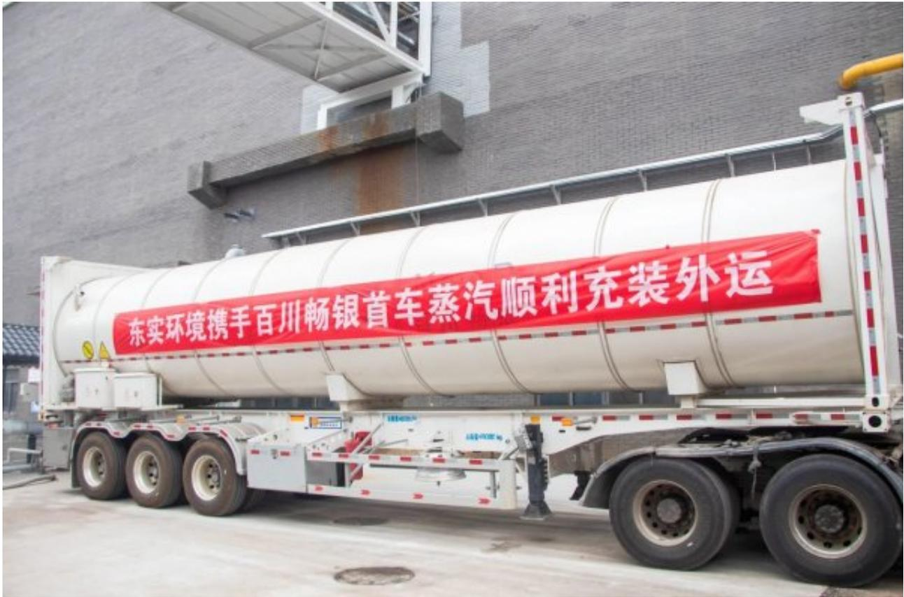
什么是移动供热储能？“移动储能”不是电能，而是热能，它是一个“移动储热宝”，以蒸汽/热水的形式，把热能通过管道储存至移动供热车的储能罐体内，并用牵引设备运输到用热处，满足工业用热、居民供暖和生活热水等需求。它打破了管道运输的传统模式，是热量输送技术的一种革新。
