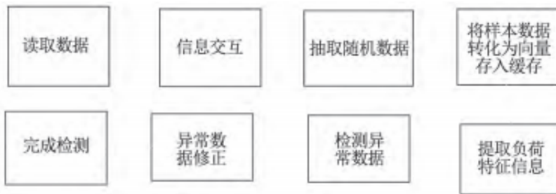
图 2 电力设备异常数据检测流程示意图
