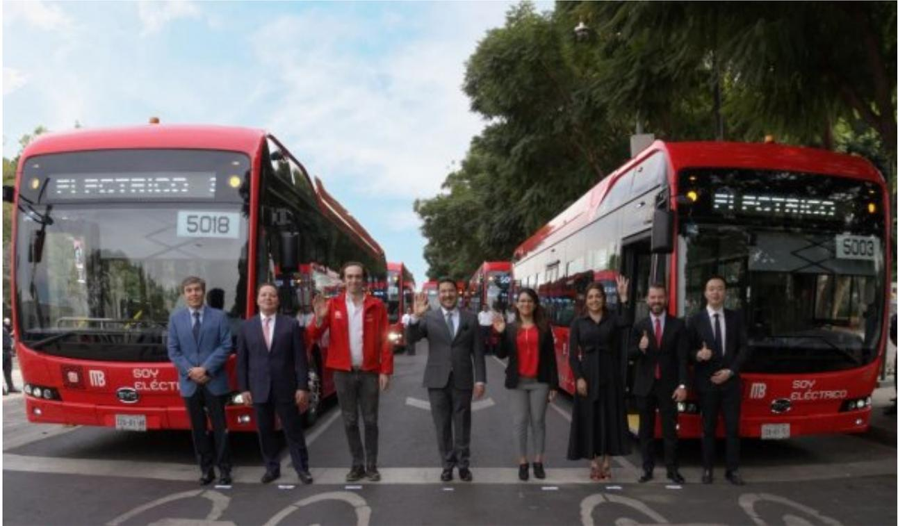
本次交付的比亚迪电动大巴车长15米，地板较低，方便乘客上下车；最大载客量为130人，续航里程达到200公里，电池容量为300千瓦时，充电时间短至3小时。电动大巴行驶静谧，有助于减少噪音污染。此外，本批电动大巴特别为残疾人士提供了无障碍设施设备，并降低了悬架高度，为特殊乘客提供便捷、舒适的无障碍出行体验。为保障公共安全，这批电动大巴还增设了连接到控制中心的通信系统，可实时同步车内情况。
