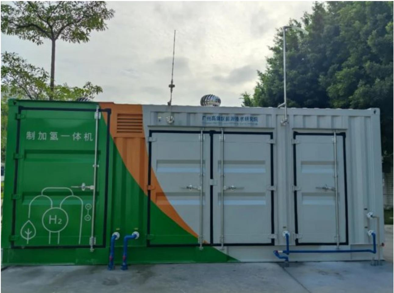
针对分布式场景用氢需求，为减轻加氢站运维成本，满足燃料电池汽车推广用氢需求，能源技术研究院牵头完成了全国首套PEM电解水制氢加氢一体机，并成功进行示范应用。示范样机的制氢能力为 $10\text{Nm}^3/\text{h}$ ，产氢压力为1-4MPa，氢气压缩机排气压力为45MPa。该设备主要由制氢及纯化系统、压缩系统、加注系统、冷却系统、控制系统、辅助系统等组成，氢气纯度满足GB/T37244-2018《质子交换膜燃料电池汽车用燃料氢气》。整套装备结构紧凑、随制随加、节能高效，可以灵活布置，满足不同场景需求。
