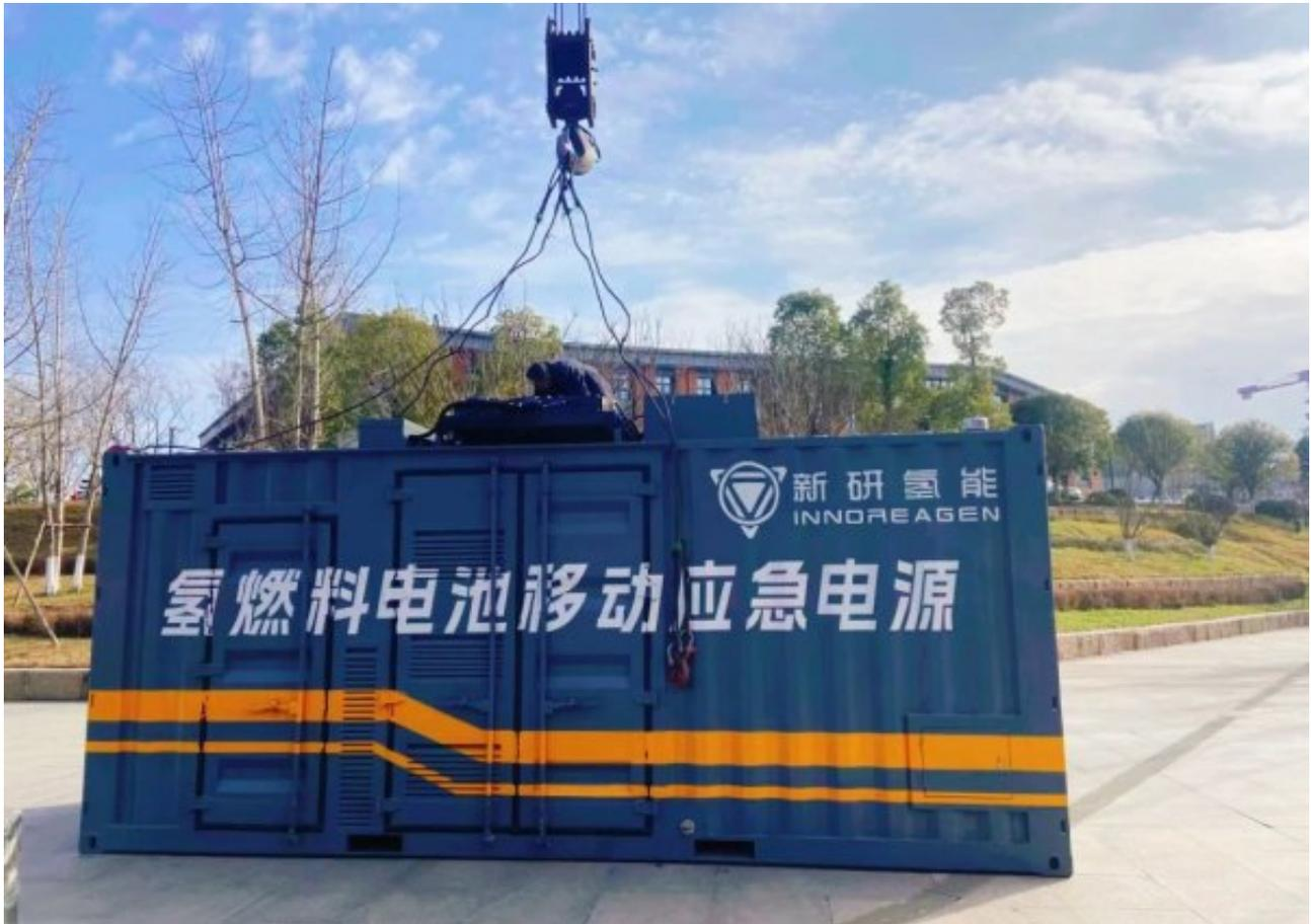
新研氢能氢燃料电池移动应急电源以氢为能源，该电源旨在攻破启动速率，整机寿命等核心关键技术，相比较传统的应急电源，不仅实现了100%绿色低碳用能，还集成了储氢系统、供氢模块、燃料电池发动机系统、储电模块、热能输出模块、电力转换模块系等多种原件。储氢系统满氢情况在200kW 额定发电功率下持续供电4 小时以上。电站内控温系统可使其适用不同的工作环境。相比于同类的应急电源，该电源可将燃料电池发动机产生的热能以及水进行收集再利用，实现恶劣条件下电力、热力以及饮用水全链条无污染的供应。
