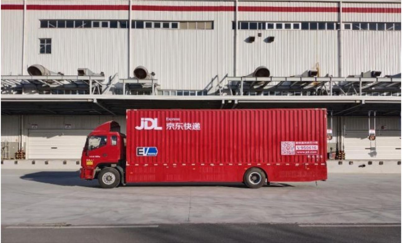
据悉，此次投用的氢能源物流卡车单次运载量达18吨，仅需10分钟便可完成氢燃料加注，加注一次氢燃料可实现400公里“超长续航”。相较于传统油车、电车，氢能源物流车具备较强的环境适应性及使用周期的特点，即便是在下至零下30度，上至45度高温，车辆依然能够稳定正常运行，使用时长可达10年。在降低碳排放的同时，规模化投用氢能源车更进一步助力成本降低。
