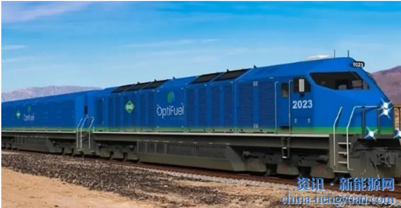
5600马力的净零可再生天然气(RNG)线路运输机车(图片由OptiFuel Systems提供)
