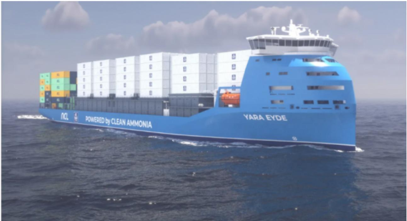
GREEN SEALION 1400属于欧洲内支线船型，主要服务于挪威-德国航线，可装载约1400个20英尺标准集装箱，配备氨燃料发动机、氨燃料储罐、供给系统和加注系统；船舶能效设计指数（EEDI）满足第三阶段要求，低于基线约45%，碳强度指标（CII）评级A级，每年可减少约1万吨二氧化碳排放。
