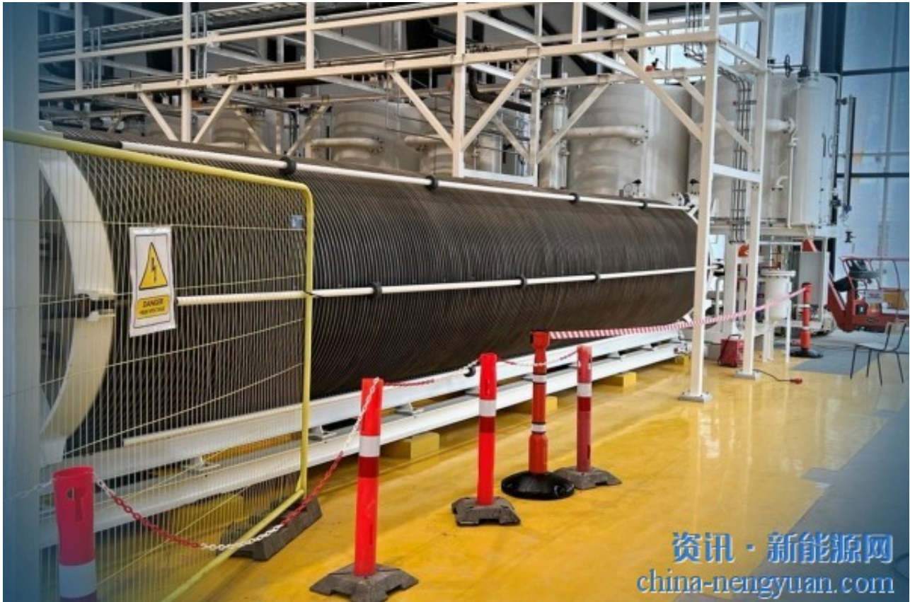
丹麦弗雷德里西亚HySynergy 1项目中的Nel电解槽。图片：Everfuel
