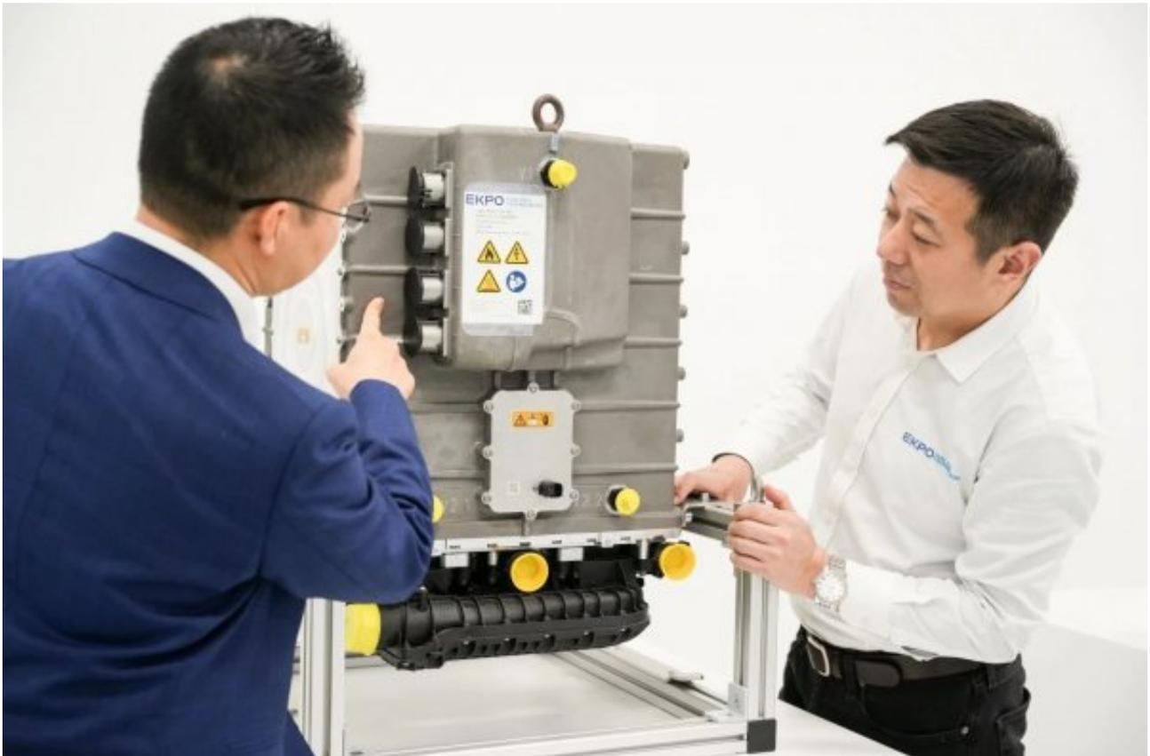
“NM12-Single”质子交换膜燃料电池电堆模组适用于乘用车和轻型商用车领域的应用。它能够提供高功率密度，结合紧凑型设计和轻量化。依托稳健可靠的技术，致力于低氢消耗，以降低运营成本和延长续航里程。此外，通过功能集成的介质模块，简化了系统集成，保证了质量，并提供了完备详尽的文档。所有EKPO电堆平台的产品，包括“NM12-Single”，均严格遵照现行汽车行业标准，在自动化的生产线中制造而成。
