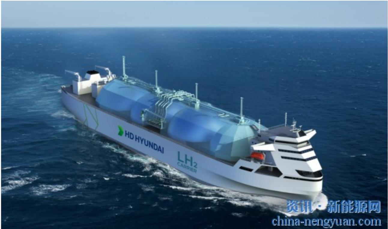
3M公司和韩国现代造船&海洋工程公司(KSOE)签署了一项联合研究项目协议，将利用3M公司的高强度、低密度中空玻璃微球Glass Bubbles开发大型液氢储罐。此次合作研究的重点是开发用于液态氢储存和运输的高性能真空绝缘系统。
