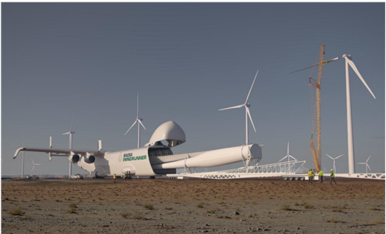
叶片产出后将直接从工厂车间装载到飞机上，抵达风电场后，也只需用吊车将其从机舱后部吊出即可进行安装。
