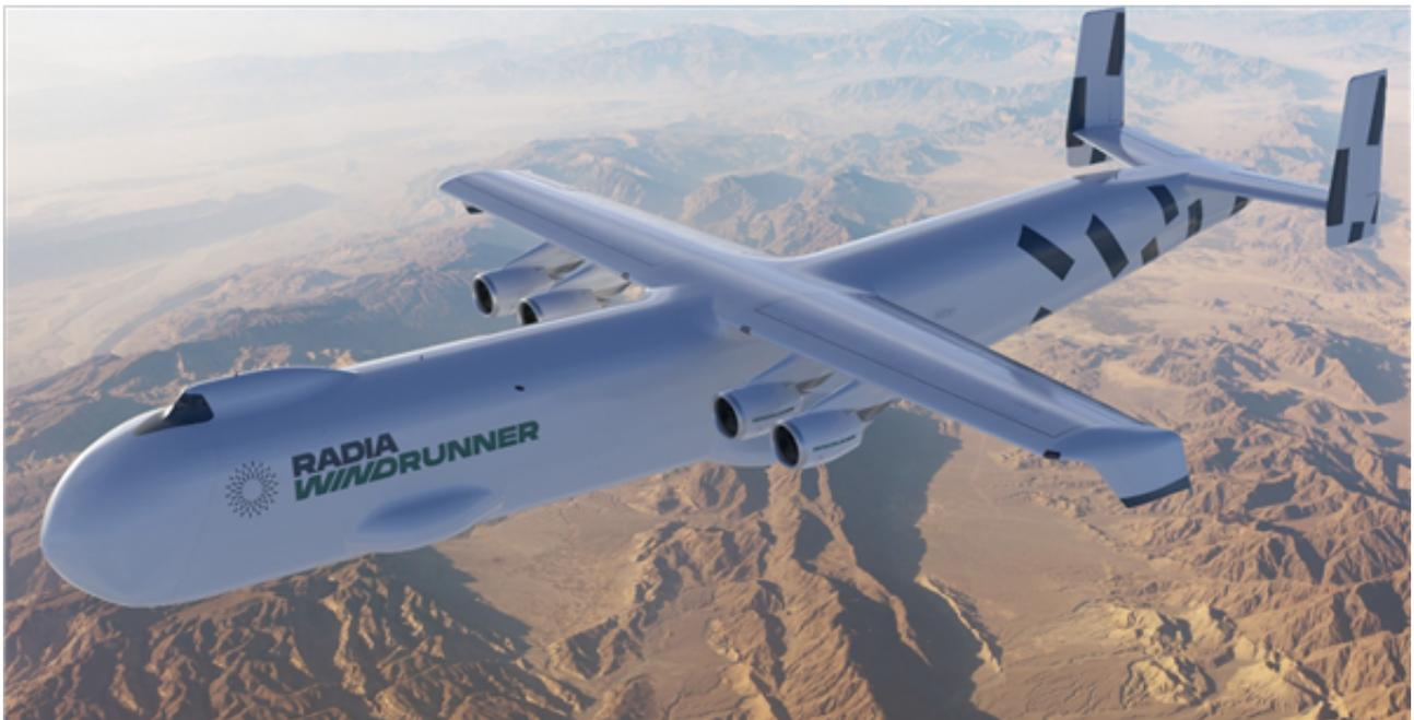
该飞机的长度为108米，高度为24米，翼展为80米，最大有效载荷长度为105米，最大有效载荷重量为72575千克，最快巡航速度0.6马赫，最高飞行高度为12525米，货舱容积约为8200立方米，是安-225的七倍。
