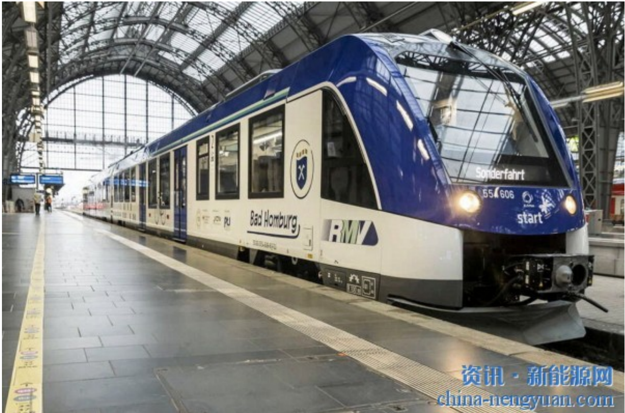
图为法兰克福火车站的一辆阿尔斯通氢动力列车。图：RMV
