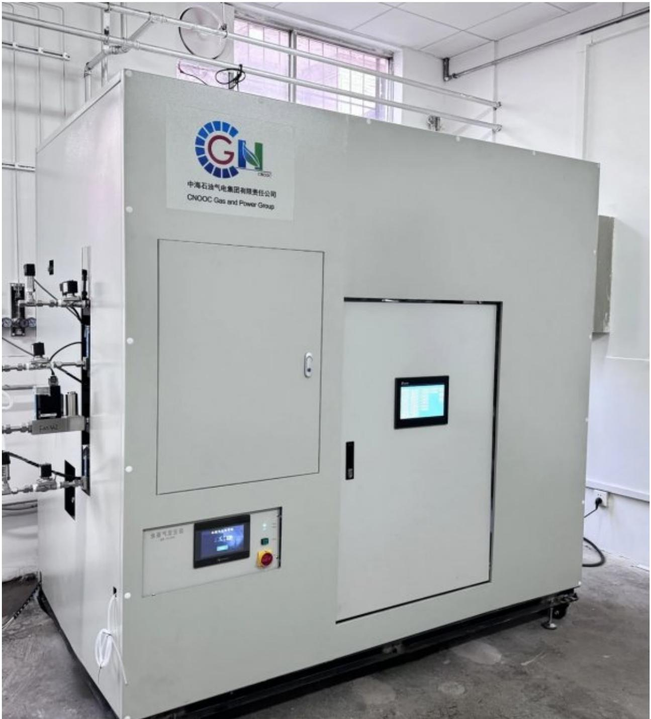
3月8日，由技术研发中心自主研发的管式固体氧化物燃料电池测试系统顺利通过技术指标考核。该系统依托国家重点研发计划“氢能技术”专项课题，是国内首套适配管式高温固体氧化物燃料电池的测试系统。
