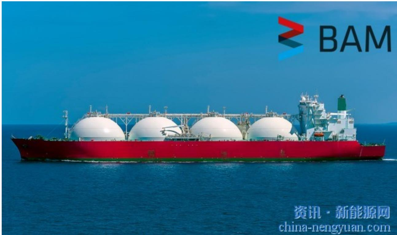
目前，液氢的运输和储存是使用球型储存装置。然而，这并不是大规模使用的最佳选择。因此，由联邦材料研究与测试研究所(BAM)领导的一个欧洲联盟正在研究一种新的、开创性的存储概念。目标是将合适的储罐容量增加40倍，同时将成本降低80%。
