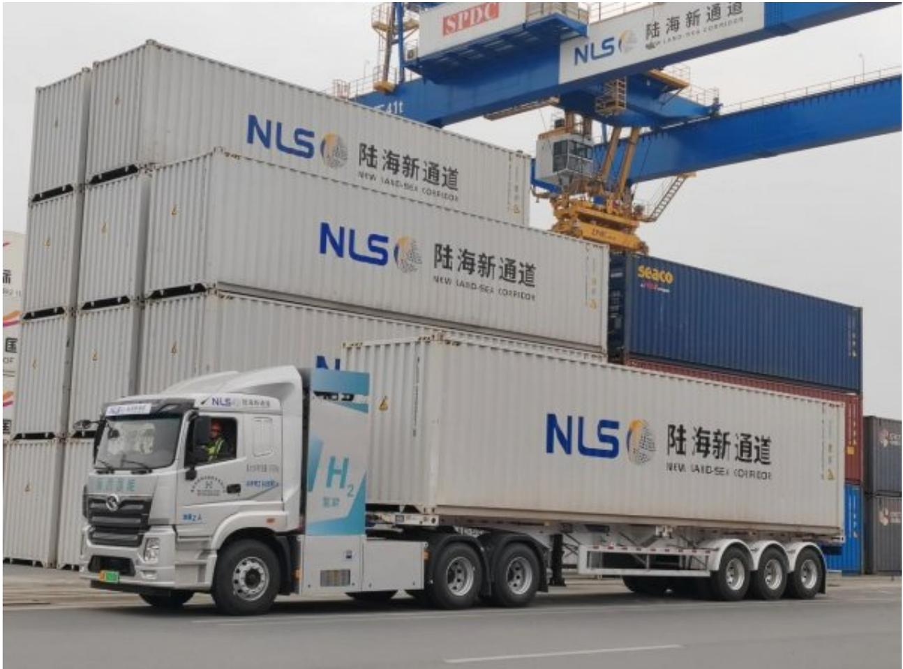
据悉，该车搭载国鸿氢能110KW氢燃料电堆系统，仅需10分钟便可完成氢燃料加注。加注一次氢燃料可实现400公里以上续航。按照每辆车每年行驶里程5万公里计算，10辆车可减少近500吨二氧化碳排放。在降低碳排放的同时，规模化投用氢能源车还使得短驳成本降低10%左右。
