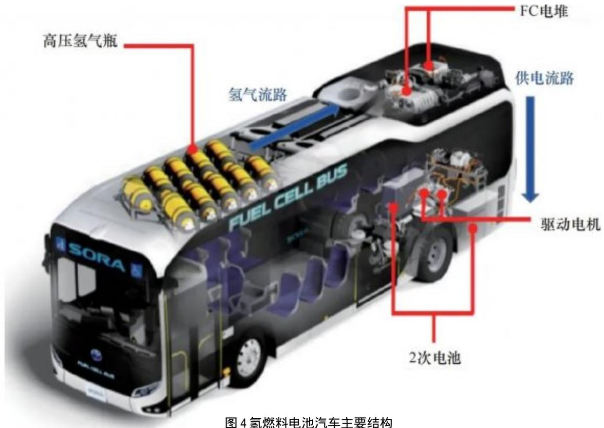
图4 氢燃料电池汽车主要结构
