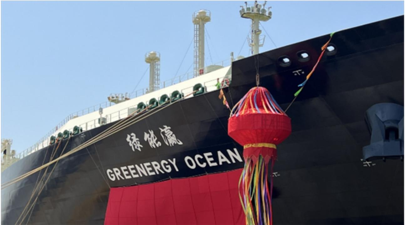
该船采用最新一代的双艏鳍线型设计，集成了多项低碳节能技术，其钢材用量高达2.5万吨，甲板面积相当于三个标准足球场大小，足以装载17.4万立方米的液化天然气，满足700万个家庭一个月的用气需求。
