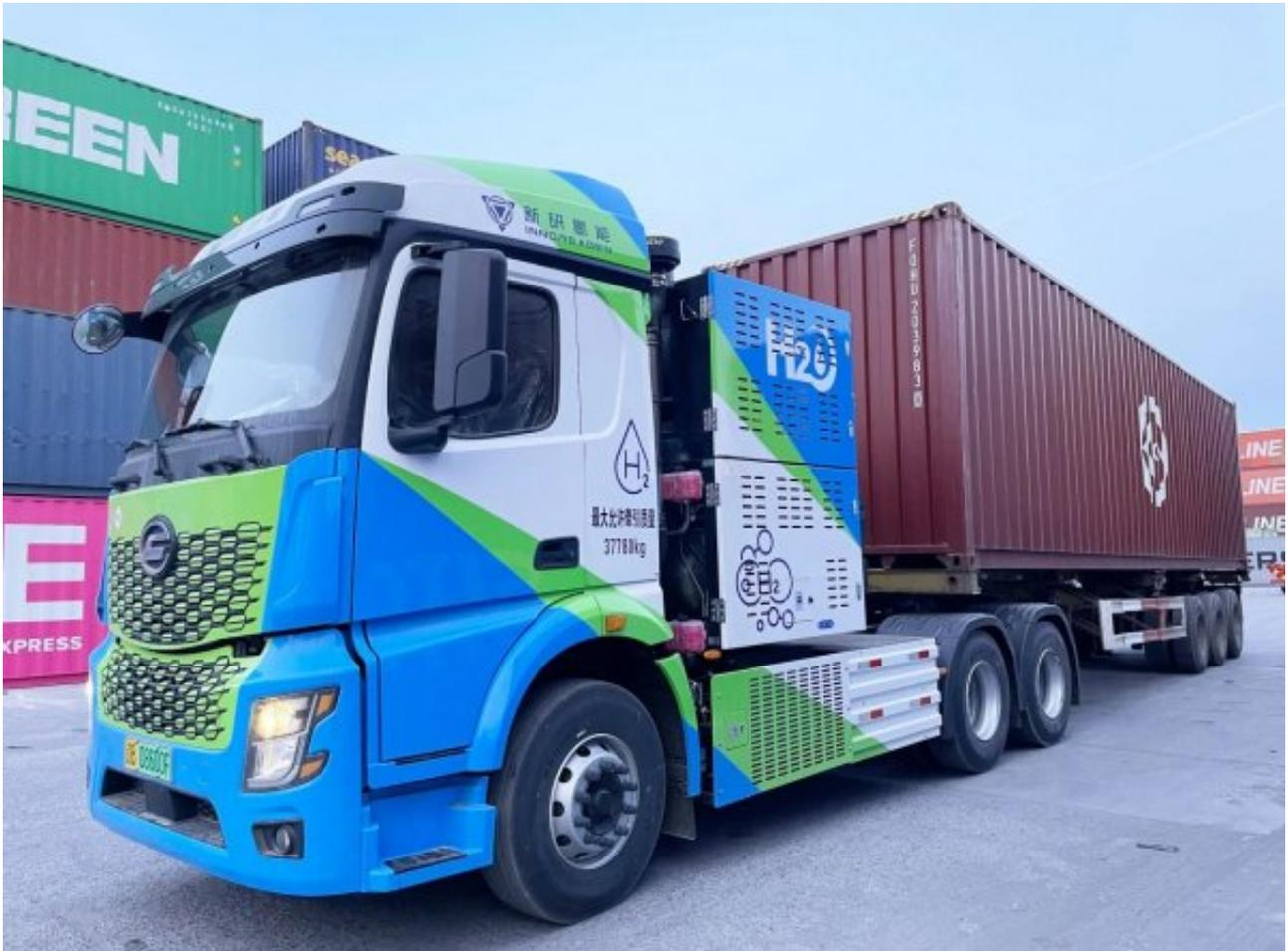
港口物品多样化、运输量大、货品丰富是可观的氢能重卡短倒运输场景，为氢能燃料电池车提供巨大的运力支撑。在具有优势的同时，港口运输条件对车辆要求严苛，再加上北方气温温差大，这对氢能重卡的可靠性、在极端环境下持续稳定运行的能力，提出了更高的要求。本次在大连港集装箱码头投入运营的新研氢能重卡具有载重大，补能快，零污染，长续航里程等特点，能满足码头不间断的运输需求。
