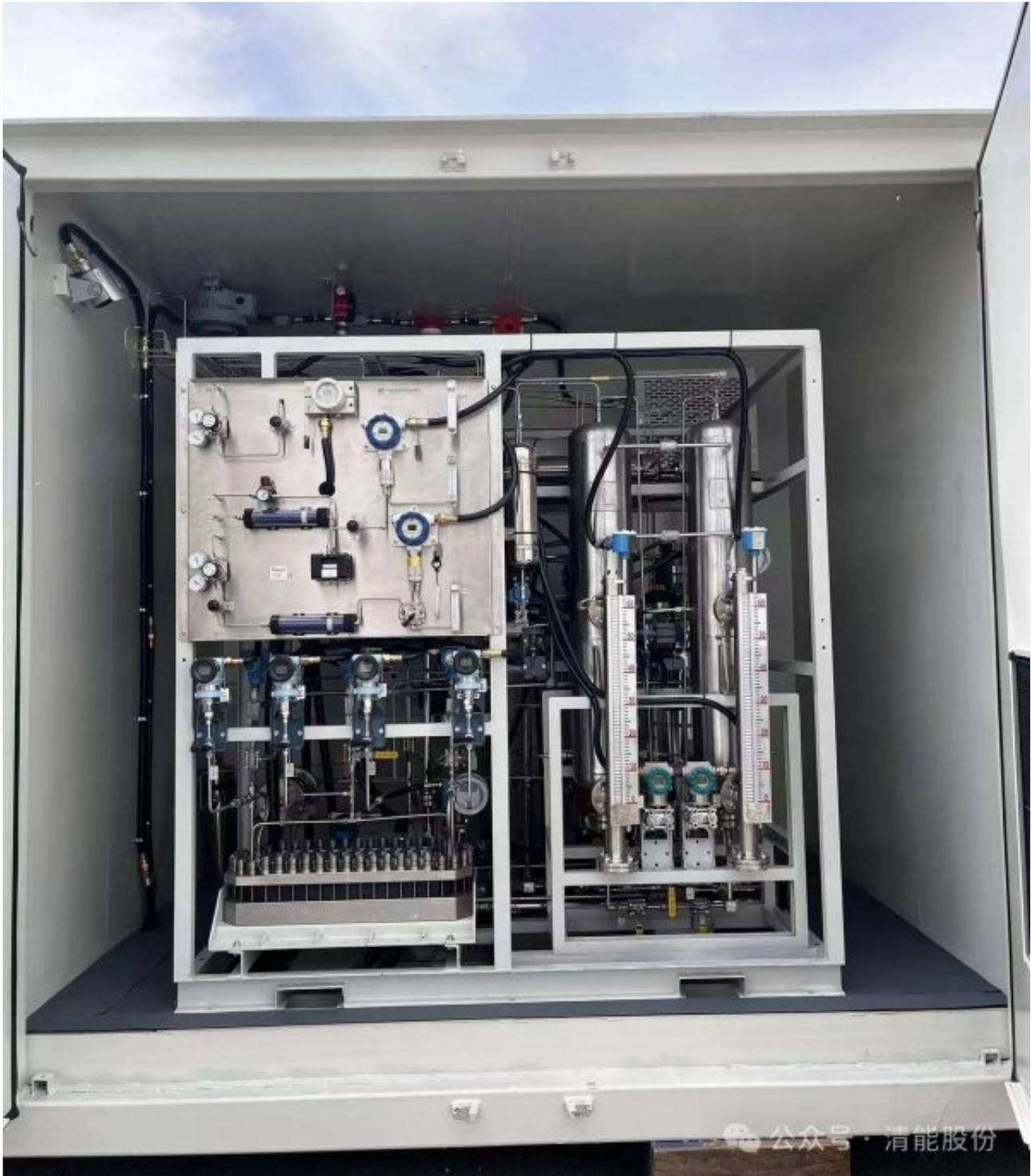
其中，PEM电解制氢系统的额定产氢量为 $6\text{Nm}^3/\text{h}$ ，电解槽效率为 $3.6\sim 4.4\text{kWh}/\text{Nm}^3\text{H}_2$ ，系统具有高电流密度、高氢气纯度、快速启停和调节功率的特性，可自动跟随输入电源的波动情况调整运行功率及产氢量，匹配可再生能源（光伏、风电等）制氢，能够实现高效、安全和大幅度可调节电解水制氢，同时配备了清能股份自研的HyAIOps运维平台，通过多端协同实现7\*24小时无人值守。
