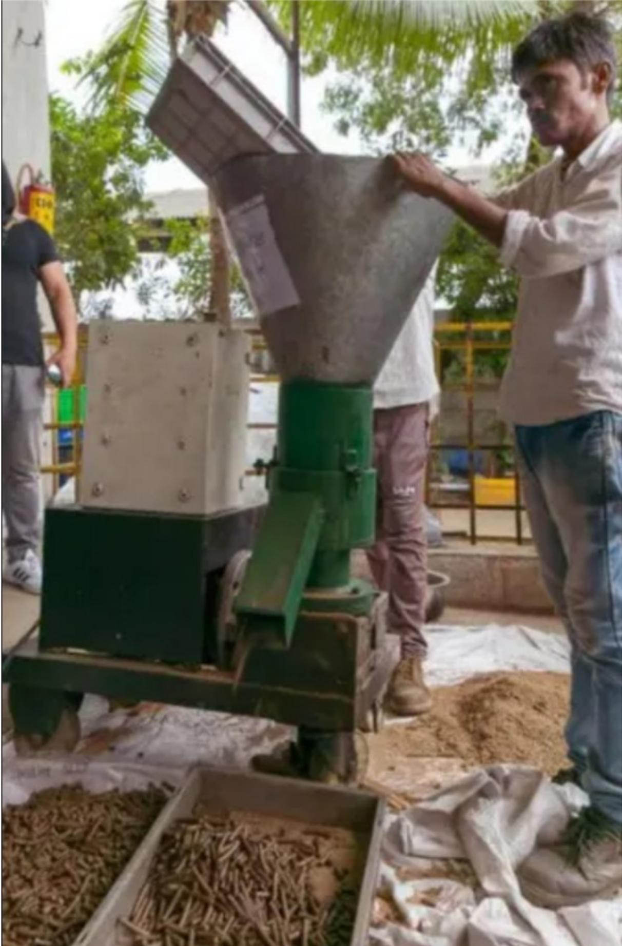
在印度工作的小型生物质制粒机。
