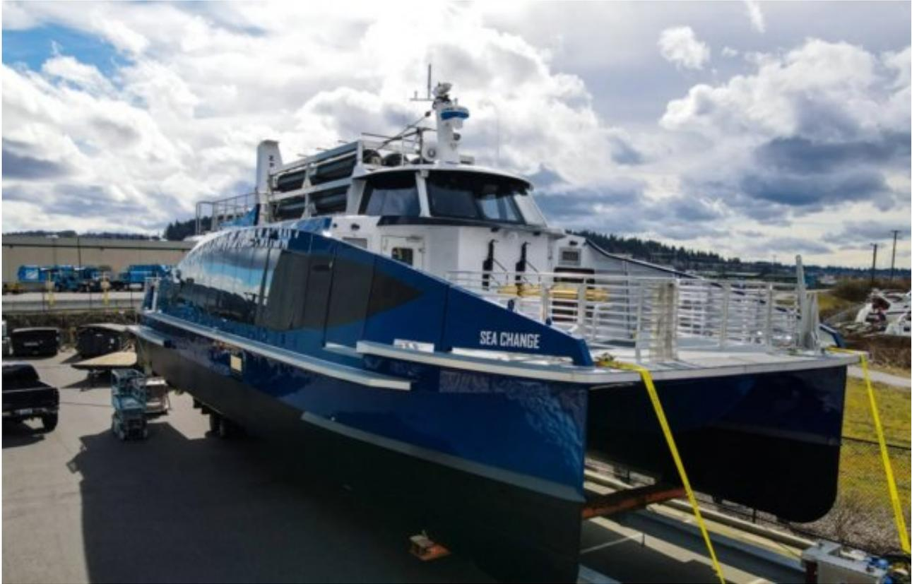
Sea Change配备了氢燃料电池，为其全电动马达提供动力。这些电池可以让船只以15节(17英里)的速度行驶300海里(345英里)，并且不需要岸上的充电基础设施。
