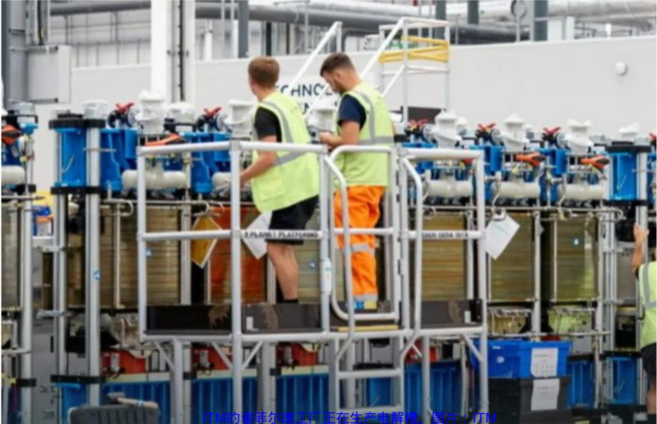
ITM的谢菲尔德工厂正在生产电解槽。图片：ITM
