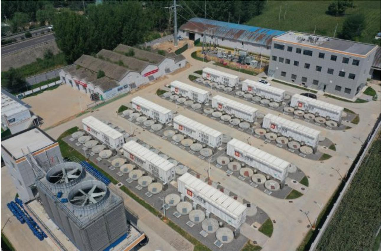
项目是国内首台电网侧独立调频飞轮储能电站，年调频里程300万兆瓦，通过实时调控有功出力参与电网调频有效解决区域电网内有功不平衡问题，为新型电力系统提供快速调节资源保障电力系统频率稳定。
