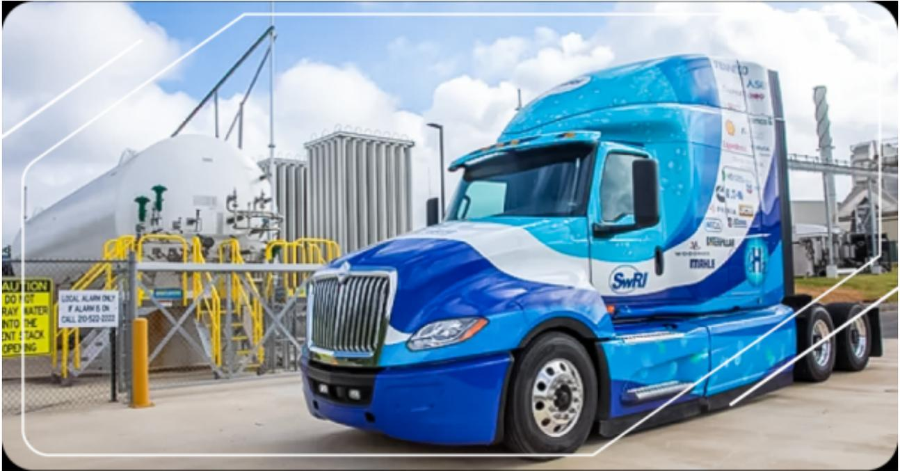
今年年初SWRI宣布了一项重大突破，其改装的氢内燃机几乎完全消除尾气中的氮氧化物（NOx），排放量显著降低，只有0.008g/hp-hr，这一数值远低于美国环保署EPA 2027排放标准，不及标准限值的1/4，并低于加州空气资源委员会（CARB）的超低NOx排放标准。在FTP工况循环测试中，与柴油发动机相比，二氧化碳排放量减少99.7%，展现了氢内燃机减排巨大潜力。
