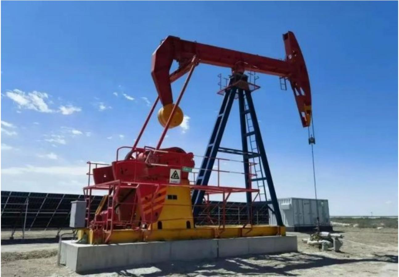
“我们利用‘沙戈荒’充足的光照优势，以‘光伏供能+24小时储能’的供电模式，替代了柴油发电抽采石油，实现边远井绿色低碳高效生产。”据新能源科技分公司王生春介绍，该系统自今年6月29日带载调试运行后效果良好，各项性能指标均达到应用需求，推动实现了油田工作效率、经济效益和绿色环保“三提升”。
