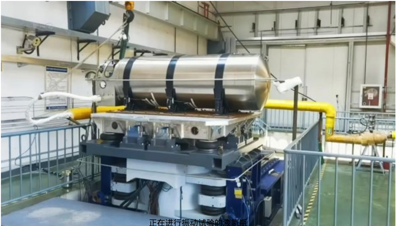
正在进行振动试验的液氢瓶
