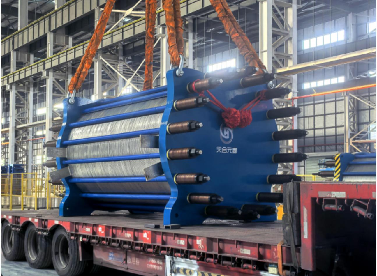
扬州生产基地首台下线的碱性电解槽，系天合元氢天擎系列二代产品，其采用了创新性的内部结构和行业领先的核心材料，通过基地智慧化全自动产线生产，电流密度较常规产品提升30%、体积缩小23%、重量减少18%、能耗降低5%，是天合元氢创新性能的一款产品。
