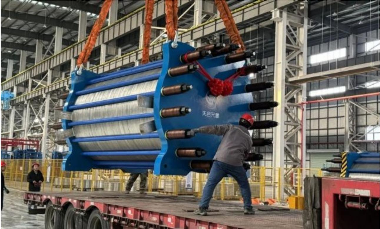
天合元氢扬州生产基地的自动化产线采用了先进的技术和设备，由极板自动焊接线、流道自动加工线、板网电极自动焊接线、电解槽组装线四部分组成。先进的设备和工艺使得生产流程更加高效、精准。产线融合了自动控制、声光电检测、VI算法、大数据、云平台等技术，保障了产品的一致性和可靠性，实现了100%自动化、100%质量自判定、100%产品数字化、100%信息共享化“4个100%”的智能产线。
