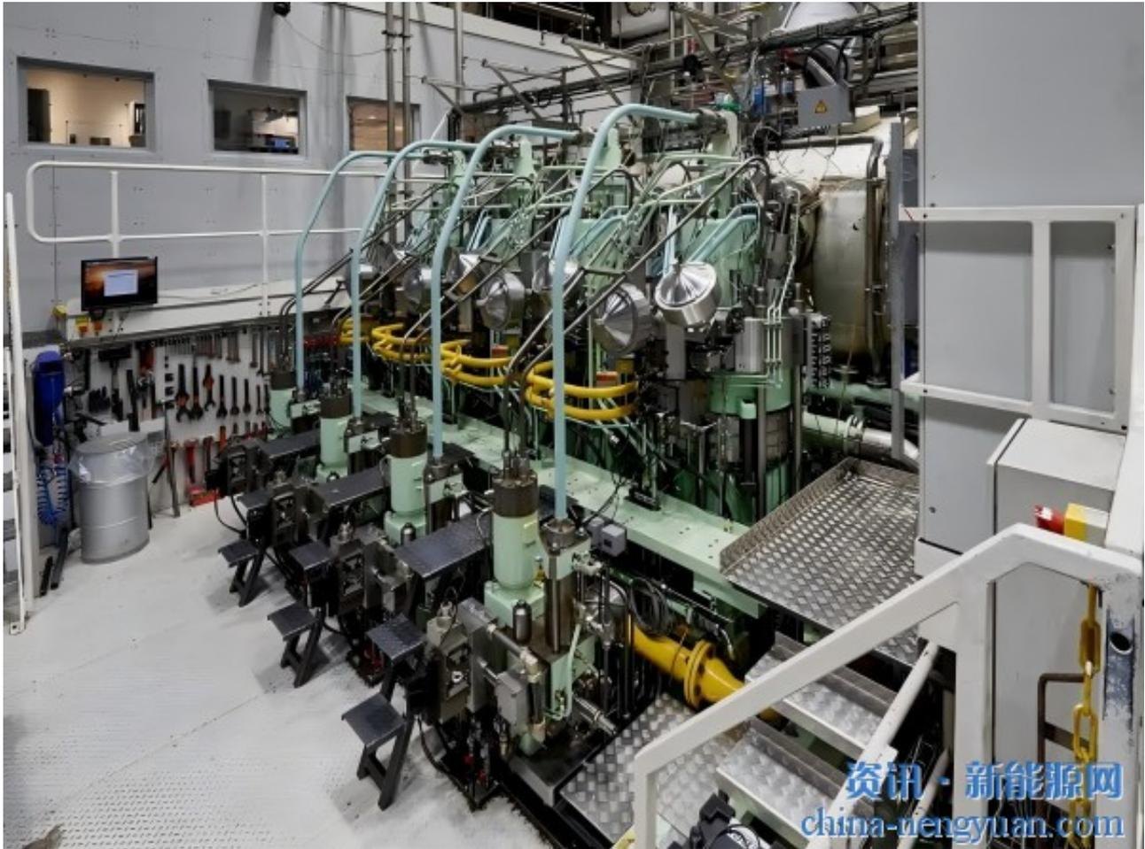
曼恩能源解决方案公司（MAN Energy Solutions）日前宣布，其ME-LGIA（液态气体喷射氨）发动机的研发进入了一个新的阶段，在其哥本哈根研究中心开始了全尺寸、以氨为燃料的二冲程发动机的测试。
