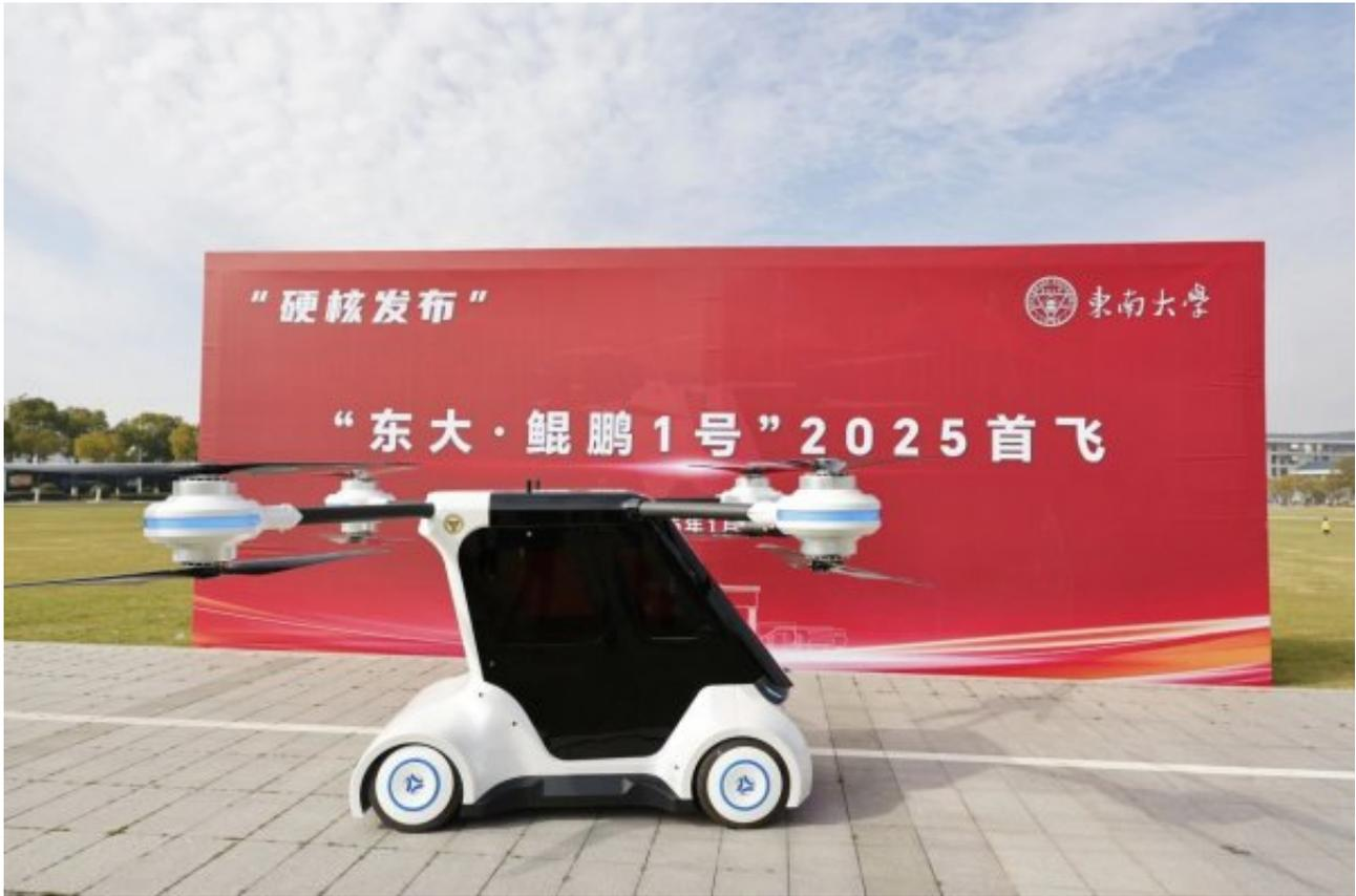
传统电动垂直起降飞行器eVTOL是以垂直起降航空飞行器作为主要发力点开展的研发，不具备地面移动能力，而“东大·鲲鹏1号”为陆空一体构型，兼具地面运载装备的快速移动与空中运载装备的灵活移动能力。
