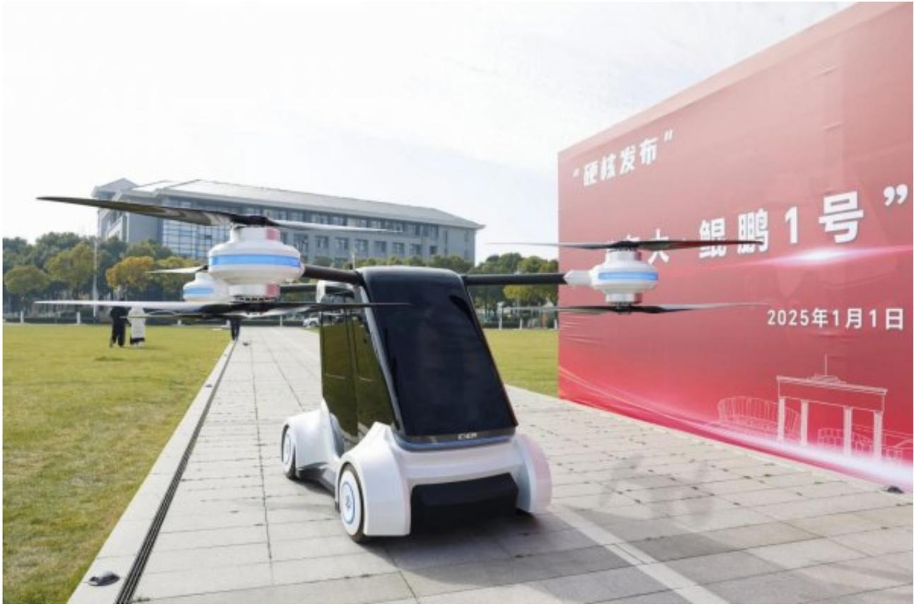
据悉，“东大·鲲鹏1号”整机尺寸为 $2.1 \times 1.2 \times 1.5\text{m}$ ，最大起飞重量500kg，飞行续航时间 20min，最大飞行高度 300m；地面运动模式基于四轮毂分布式电驱动系统，前后双阿克曼转向，电液复合制动，最高时速60km/h。
