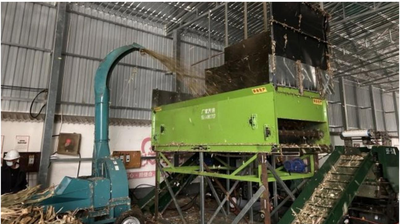
在保障发电厂资源化利用主渠道基础上，街道积极推进多途径综合利用。建设实施老王村秸秆综合利用项目，采用秸秆黄贮饲料化利用技术，回收、粉碎、打包、转运全流程机械化作业，将秸秆转化为优质黄贮饲料，与本地畜牧养殖企业建立合作机制，年消耗秸秆量超10000吨，有效降低养殖成本并减少资源浪费。
