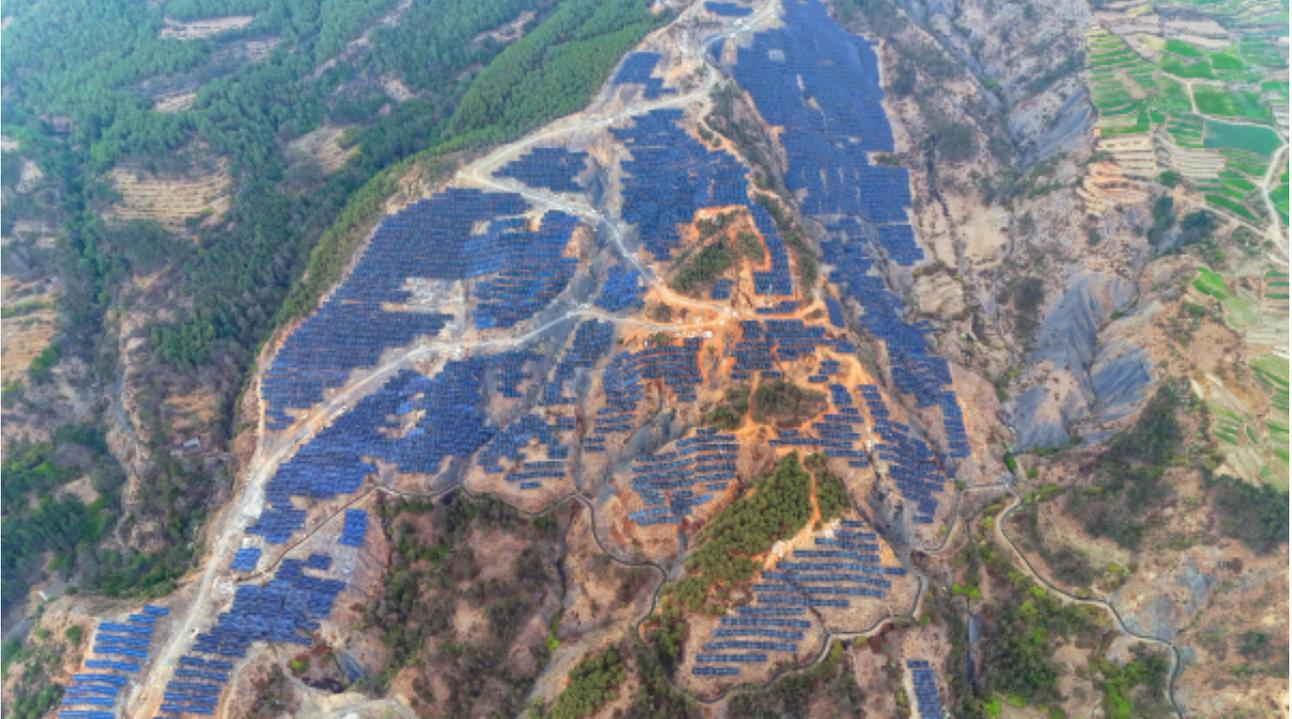
鹤庆松桂光伏发电项目核准装机容量80兆瓦（交流侧），实际装机容量80兆瓦（交流侧）、规划安装容量96.014兆瓦（直流侧）。此次首次并网主要完成范围为220千瓦升压站、光伏区2#地块，项目建成后，年平均发电量近1.45亿千瓦时，年平均利用小时数可达1486.44小时，年二氧化碳减排119133余吨，年节省标准煤43475吨，将为当地经济、社会和生态的可持续发展提供有力支撑。
