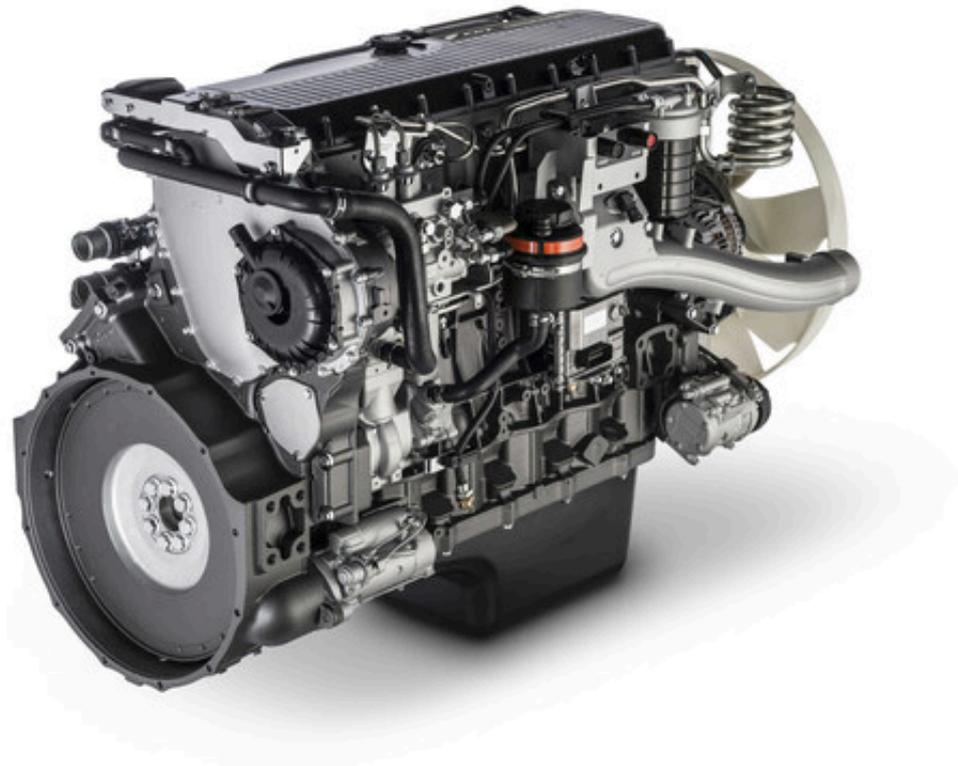
CURSOR 13 的优势在其升级迭代过程中得到了进一步加强，由此诞生了 XCURSOR 13 发动机中，XCURSOR 13 是菲亚特动力科技首款裸机硬件相同的多燃料发动机，作为依维柯 2024 年款车型产品系列的一部分推出。XCURSOR 13 采用了全新的空气处理技术以实现降速运行，通过增加高压共轨和峰值气缸压力来改进燃烧效果，采用了智能机油泵和水泵，采用了可减少摩擦的新型连杆销和曲柄销材料，以及先进的气门机构、更轻的缸体和缸盖，这些改进使其将 1998 年推出的 CURSOR 系列产品的优良传统推向了更高的水平。与上一代产品相比，它的二氧化碳排放量减少了 7%，重量减轻了 10%，最大输出功率可达 600 hp，峰值扭矩为 2,850 Nm。
