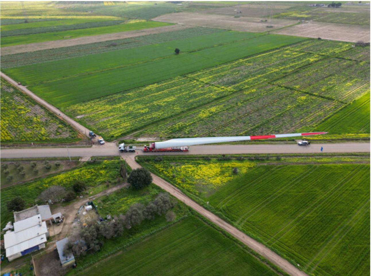
风电场等基础设施的建设涉及到非常复杂的操作：其中之一就是用总重量超过 200 吨的 12 轴特殊拖车运输长达 81 米的叶片。为了到达安装地点，他们要沿着可能包括弯道、减速带和斜坡的路线进行缓慢前行，有时甚至要求达到毫米级的操作精度，而这些路线往往远离主要公路。
